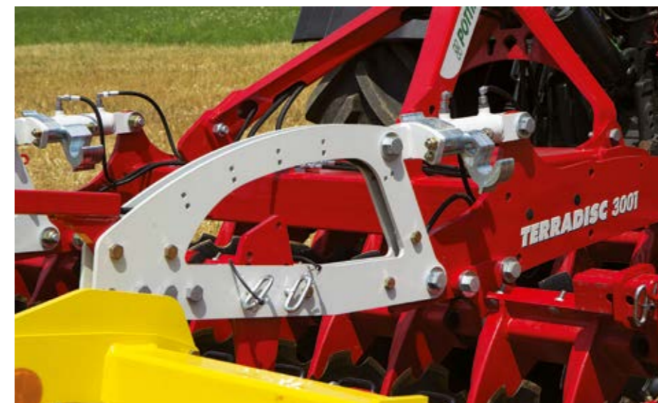
Regulacji głębokości roboczej dokonuje się przez dolożenie odpowiedniej liczby klipsów dystansowych na tłoczysko siłownika.
