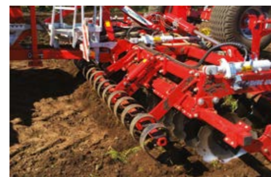
Elementy kruszące bryły nie mogą być ustawione zbyt nisko, aby nie dochodziło do zapychania maszyny.
