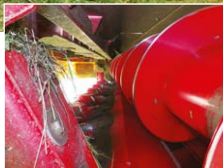
Sercem systemu Cross Flow jest przenośnik ślimakowy o dużej średnicy, umieszczony bezpośrednio za listwą tnącą kosiarki.
