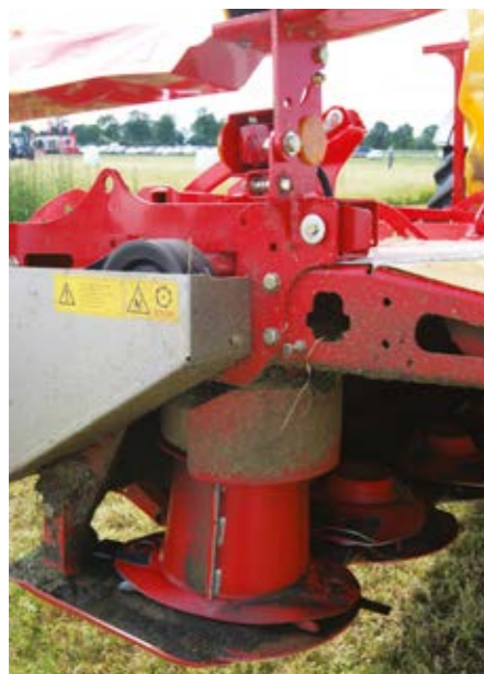
Przeniesienie momentu obrotowego na przenośnik realizowane jest poprzez przekładnię zębatą zamontowaną na ostatnim dysku listwy tnącej, pasy klinowe oraz przegub.
