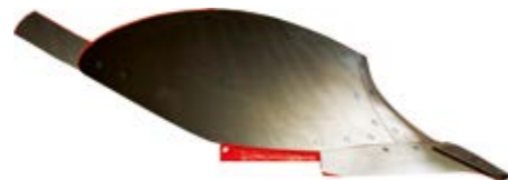
Odkładnica 41 W: wydłużony, skręcony kształt korpusu przystosowany do gleb ciężkich lepkich, oraz do umiarkowanej prędkości roboczej:
