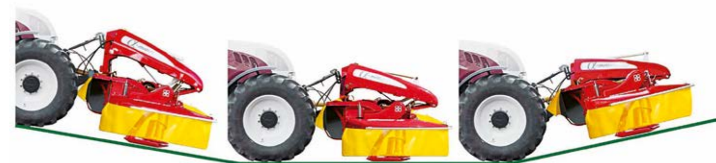
Duży zakres wychyleń wzdłużnych kosiarki zapewnia bezpieczeństwo pracy na pofalowanych łąkach, a także pozwala uniknąć uszkodzenia darni i zanieczyszczenia zielonki.
