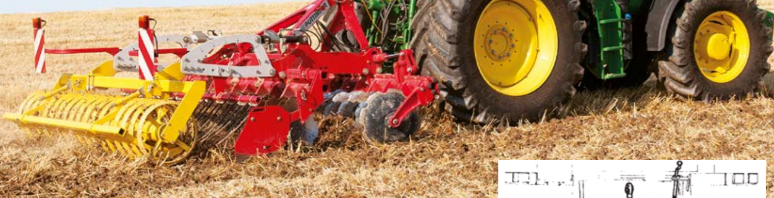
Regulacji głębokości roboczej dokonuje się przez dolożenie odpowiedniej liczby klipsów dystansowych na tłoczysko siłownika.
