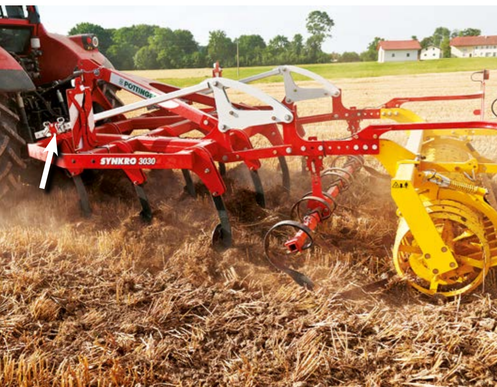
Szeroki zakres zastosowania kultywatora wymaga prostego i wygodnego nastawiania głębokości roboczej. System regulacji głębokości jest ergonomiczny i łatwo dostępny.
