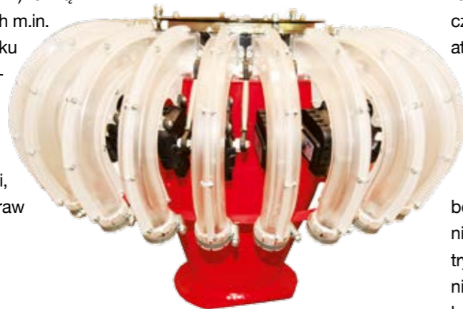
Budowa głowicy rozdzielacza gwarantuje precyzyjne rozdzielanie nasion na pojedyncze rzędy wysiewu.
